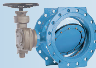
Tipo Brida De Doble Excentricidad: DN 150 a 2.000mm (PN 10, 16 y 25 Bar)
